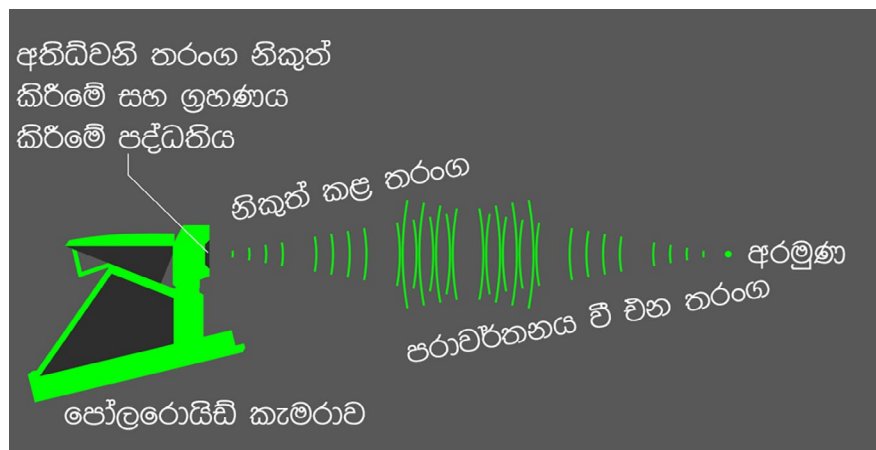
අභිධ්වනි තරංග (Ultrasonic waves) මගින් ස්වයං නාභිගත කිරීමේ තාක්ෂණය
