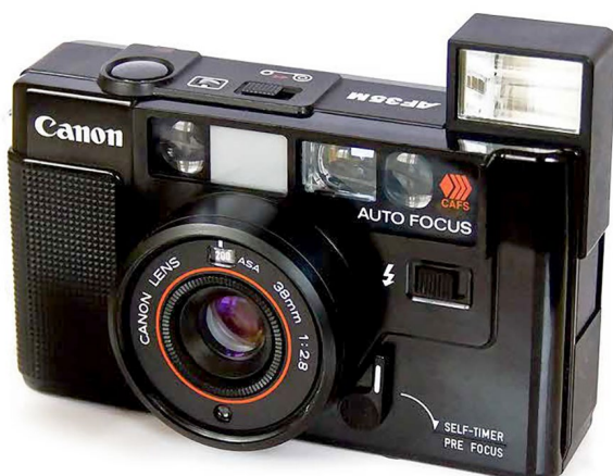
අධෝරක්ත කිරණ විමෝචක ඩයෝඩ (Infrared emitting diode) යොදාගනු ලබන ස්වයං නාභිගත කිරීමේ තාක්ෂණය
